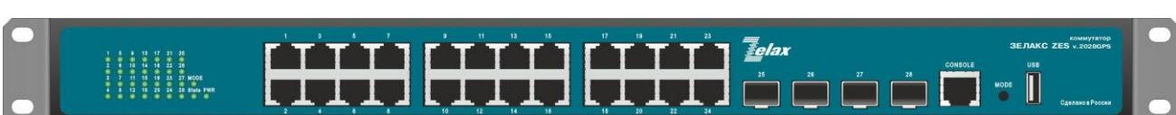
Рис. 16 — Вид передней панели коммутаторов ZES-2028GPS-AC220-A группы 2
