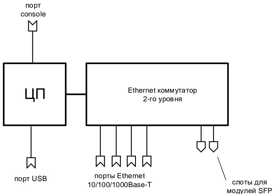
Рис. 2 — Структурная схема коммутаторов ZES-2028G(P)S-x-A
