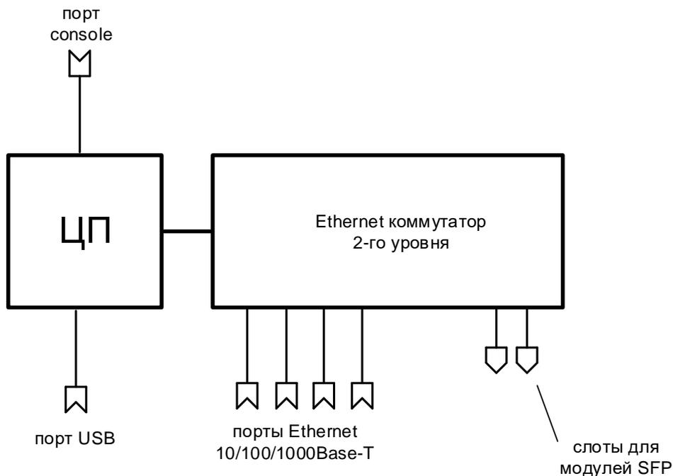
Рис. 2 — Структурная схема коммутаторов ZES-2028G(P)S-x-A
