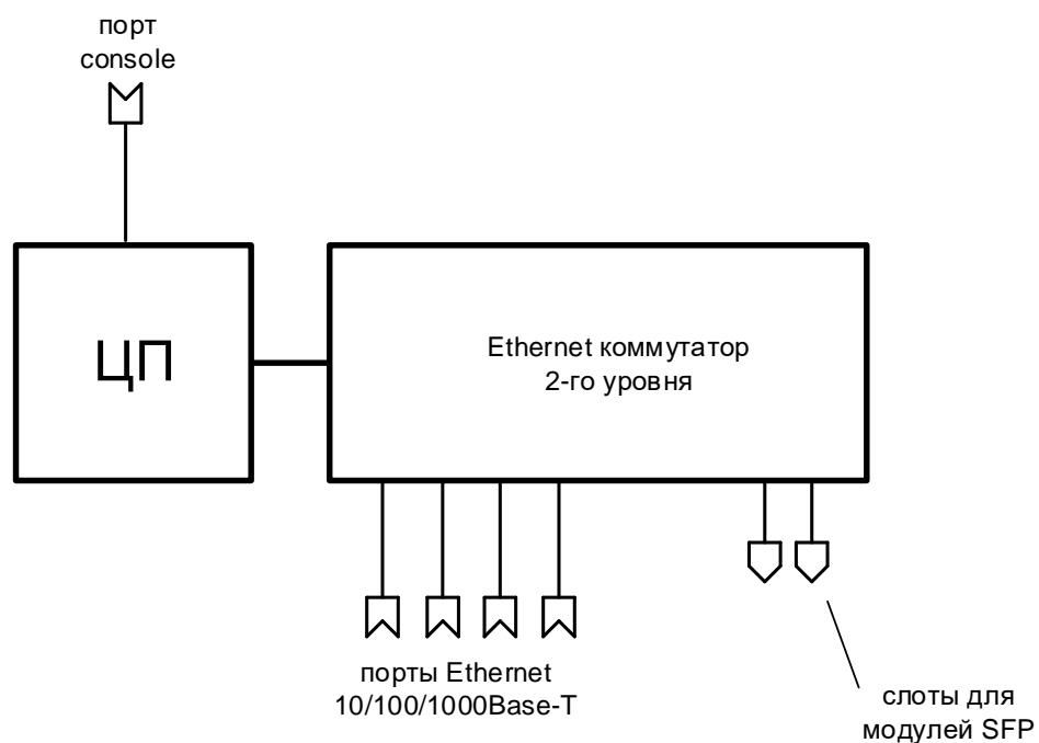
Рис. 3 — Структурная схема коммутаторов ZES-20xxG, ZES-21xxG кроме ZES-2028G(P)S-x-A
